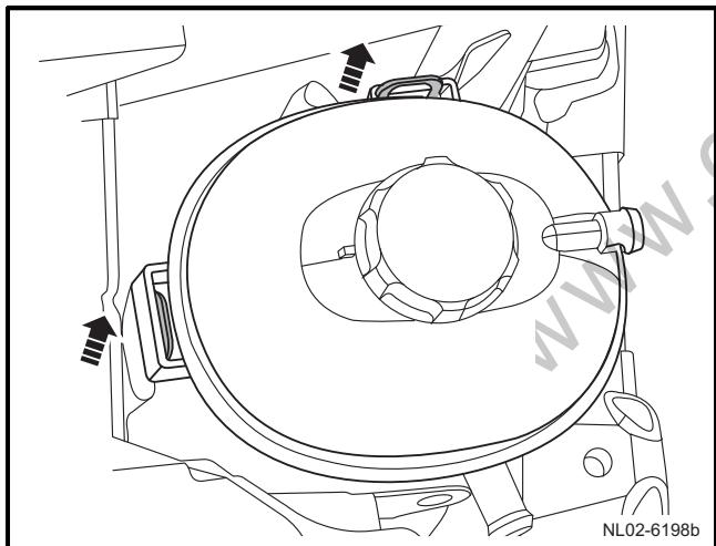
3) 从膨胀罐支承座上拔出膨胀罐总成。
